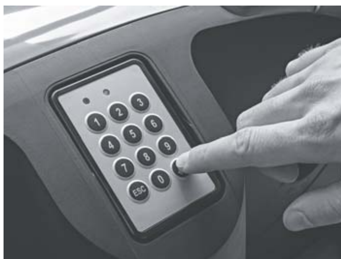
Controllo degli accessi tramite il codice PIN
